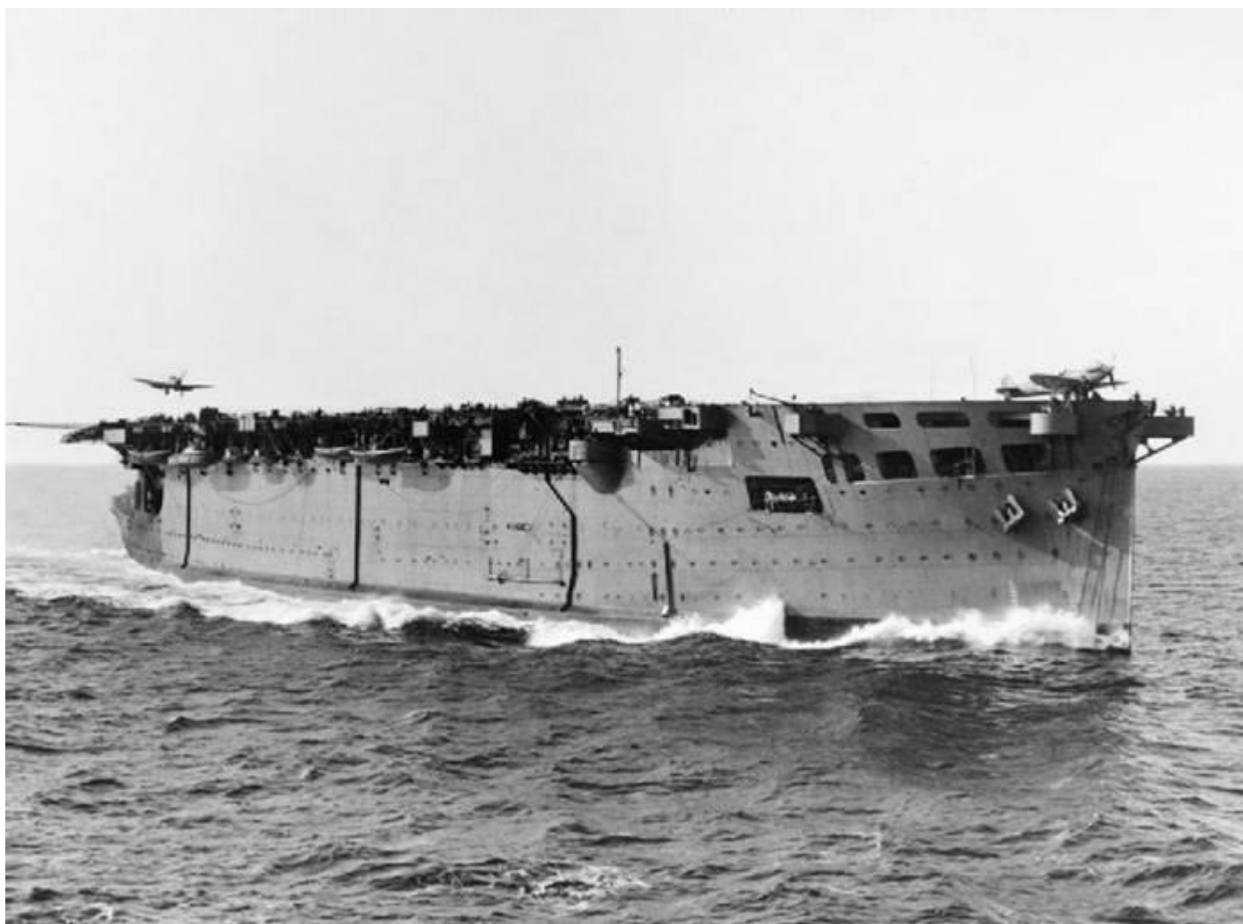
Le premier porte-avions au monde, l'Argus britannique, permettant l'appontage et le décollage, en mer, des avions à roues.
