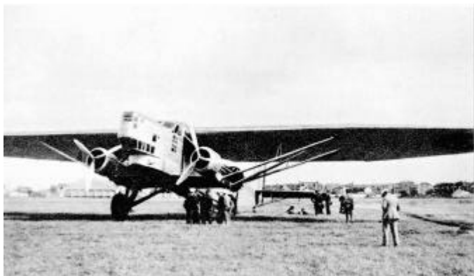
Farman F-221 (1937). Les capots NACA sont efficaces à l'avant, mais on peut se demander s'ils le sont à l'arrière !
